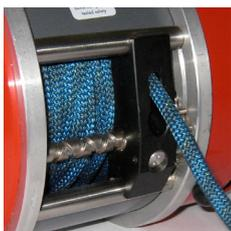
Die Winde ist ausgestattet mit einer mitlaufenden Zwangsseilführung und einer vorgegrißten Seiltrommel.
